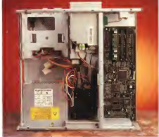
L'interno e mette a nudo il comparto ed ordinato. Gli alloggiamenti disponibili per le memorie di massa eccelle sono due.
